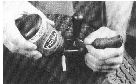
**10** Tragen Sie die Reparaturflüssigkeit beidseitig auf den Reparaturkörper auf.
