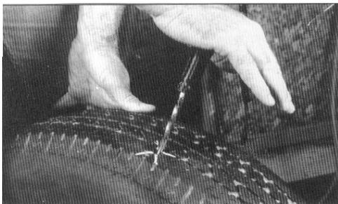
**3** Stellen Sie das Ausmaß der Verletzung fest (drehen Sie den Spiralstichling in Uhrzeigersinn, füllen Sie den Reifen zuvor auf 0.5 – 1 bar).
