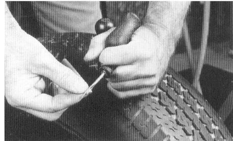
**8** Führen Sie den Reparaturkörper durch die Nadelöse. Wenn notwendig, etwas n°770 auf die Nadel geben.
