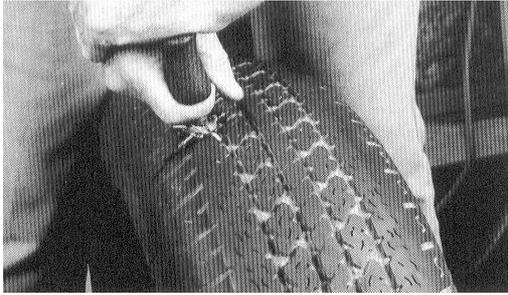
**13** Schieben Sie die Nadel bis zum Anschlag in die Richtung des Schadenskanals. Hinweis: Wählen Sie die richtige Nadelgröße.
