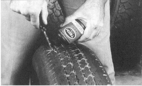
**5** Geben Sie die Tech Flow-Seal Vulk-Lösung n°770 auf den Spiralstichling.
